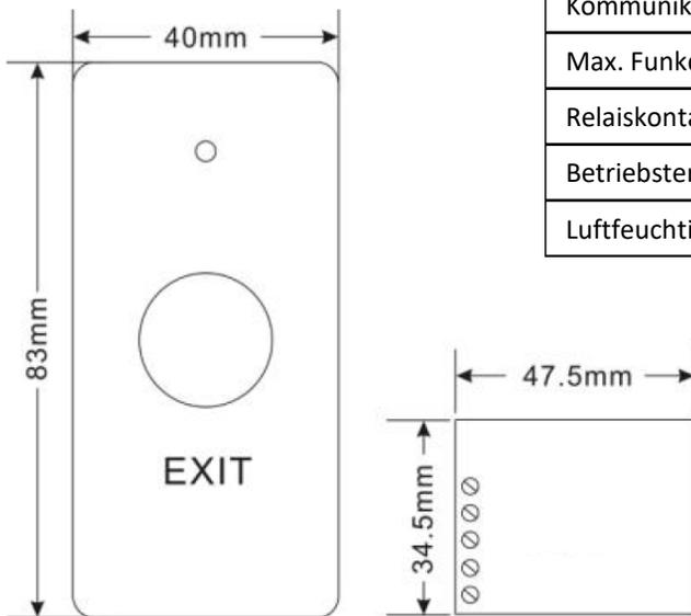
Der mitgelieferte Taster (Sender) ist bereits mit dem Empfänger gekoppelt.
