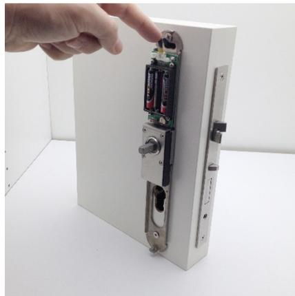
6.) Batterien 3 x AAA 1,5V einsetzen und Stecker aufstecken.
